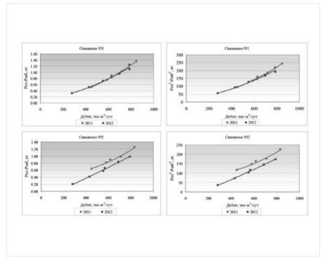
Рис. 4— Зависимость депрессии от дебита по годам, построенная по данным проведенных исследований в скважинах 931, 932
