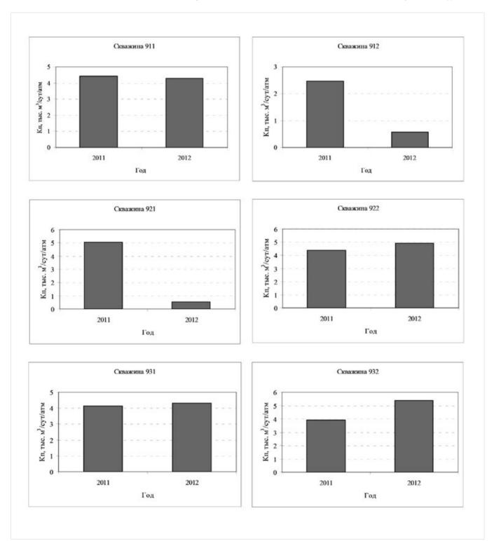
Рис. 5 — Изменение коэффициента продуктивности по данным технологических режимов работы скважин на конец 2011–2012 гг.
