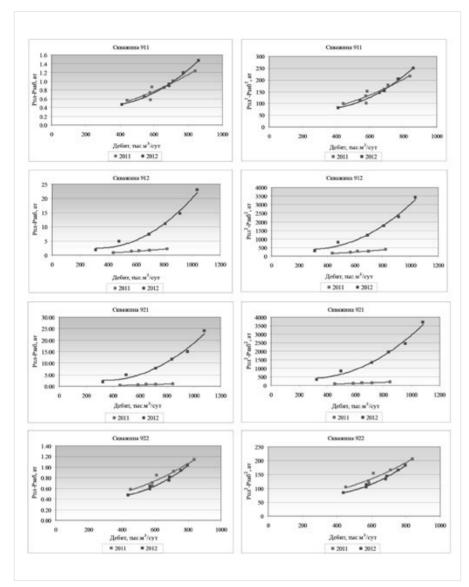
Рис. 3— Зависимость депрессии от дебита по годам, построенная по данным проведенных исследований в скважинах 911, 912, 921, 922
