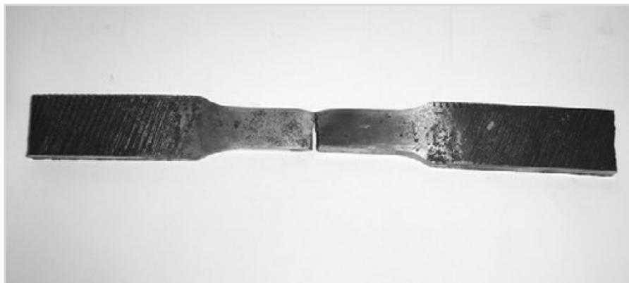
Рис. 1 — Образец материала трубы нефтепровода после циклического нагружения
