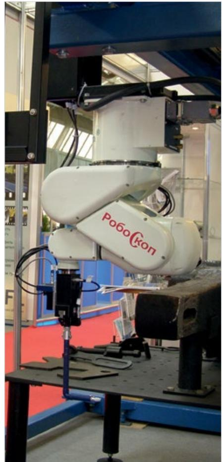
«Робоскоп 3000» — роботизированный комплекс неразрушающего контроля и лазерного обмера геометрических параметров
