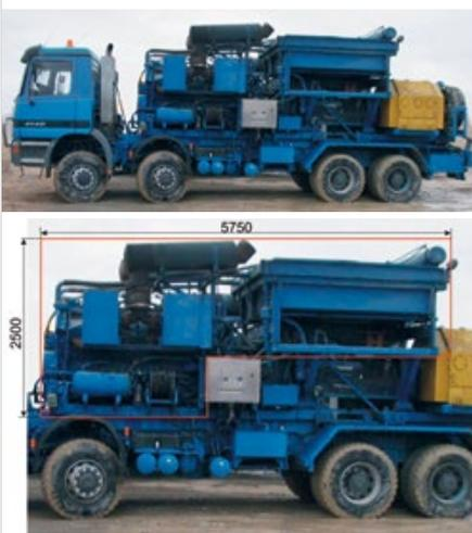
Насосный агрегат со «спаркой» из двух газотурбинных силовых установок
