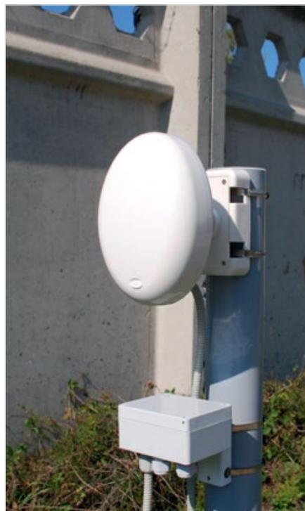
Рис. 3 — Однопозиционный извещатель «АНЧАР-40М»
