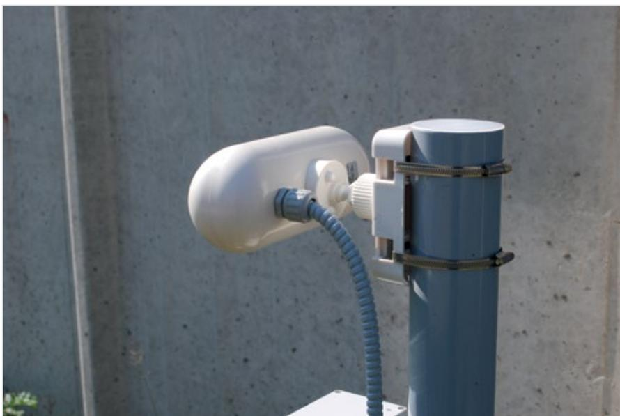
Рис. 1 — Микроволновый извещатель «Тантал-200М»
