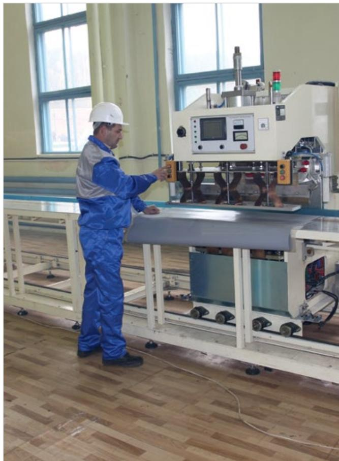
Рис. 3 — Сварка полимерного материала линией ТВЧ
