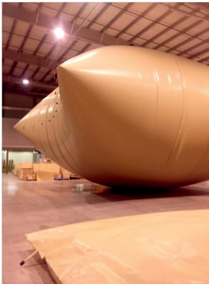
Рис. 2 — Проверка на прочность полимерного эластичного резервуара
