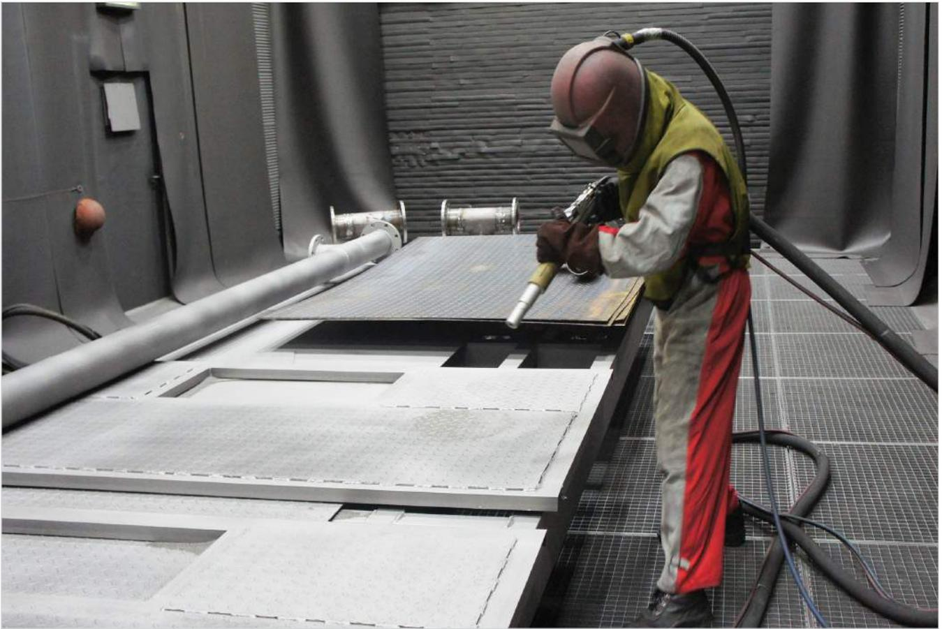
Рис. 7 — Дробеструйная обработка металлоконструкций
