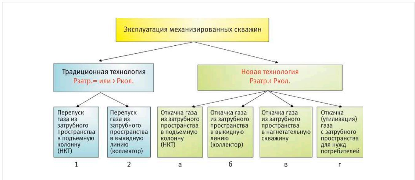
Рис. 1 — Классификация способов отбора газа из затрубного пространства добывающих скважин
