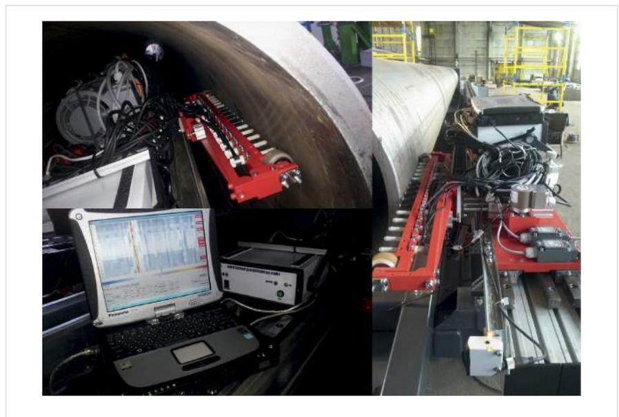
Рис. 1 — Система автоматизированного вихрекового контроля труб большого диаметра ВД-91НМ
