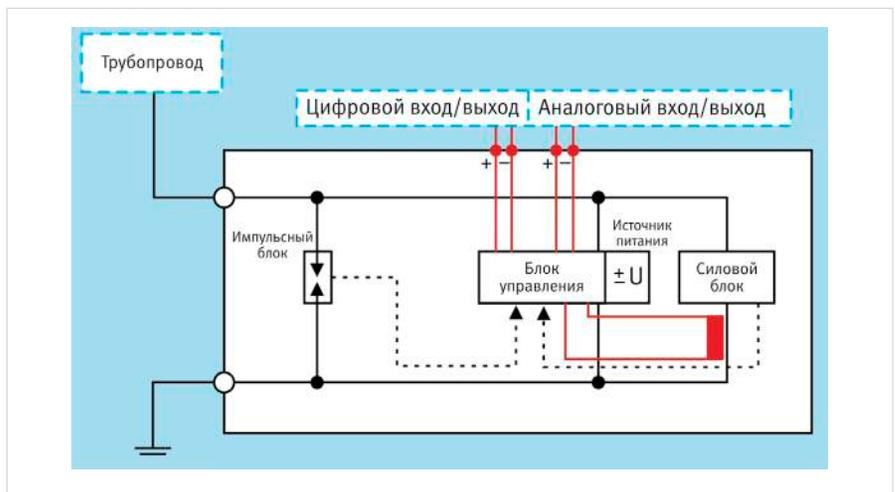
Рис. 4 — Блок-схема устройства защиты от посторонних напряжений VCSД
