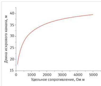
Рис. 2 — Предельные длины искровых каналов в грунтах с различным удельным сопротивлением при ударе молнии со средним током 30 кА
