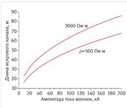
Рис. 1 — Расчетная длина искровых каналов в зависимости от амплитуды тока молнии
