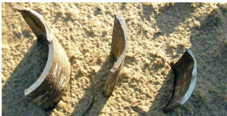
Рис. 7 — Вырезанные части трубы с коррозионными повреждениями (исходная толщина стенки — 8 мм, остаточная минимальная — около 3 мм)
