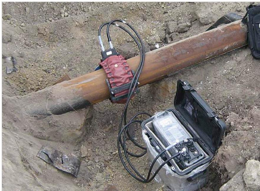
Рис. 1 — Общий вид системы «Wavemaker»
