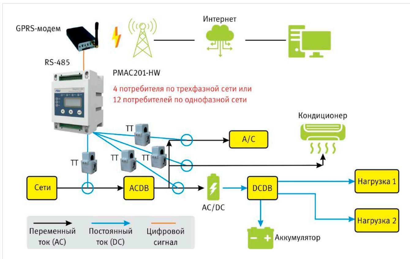
Рис. 2 — Пример подключения многоканального электросчетчика РМАС201-НВ
