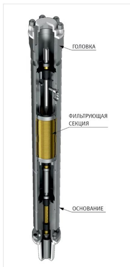
Рис. 6 — Фильтр блочный регулируемый ФБР-5
