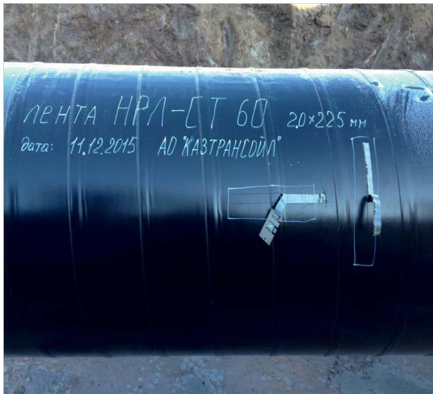
Рис. 5 — Испытания покрытия «НРЛ-СТ60» на адгезию к стали и к полиэтилену (в нахлесте)
