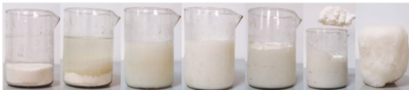
Рис. 2 — Технология приготовления изолирующего материала
