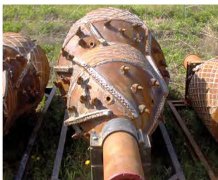
Рис. 3 — Бочкообразный расширитель режуще-скалывающего типа
