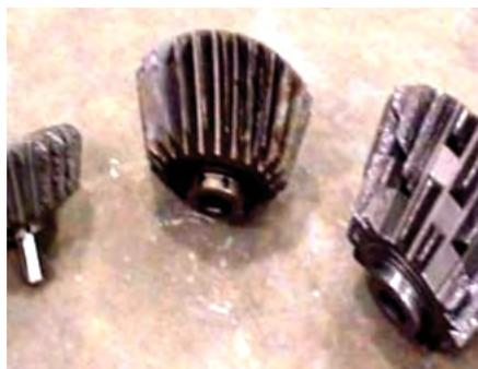
Рис. 6 — Шарошки с фрезерованным зубом
