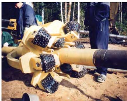
Рис. 4 — Расширитель с шарошечным вооружением для одноэтапного расширения
