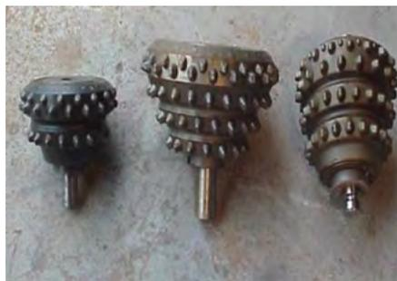
Рис. 7 — Шарошки, оснащенные вставным зубом
