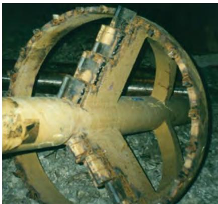
Рис. 1 — Лопастной расширитель
