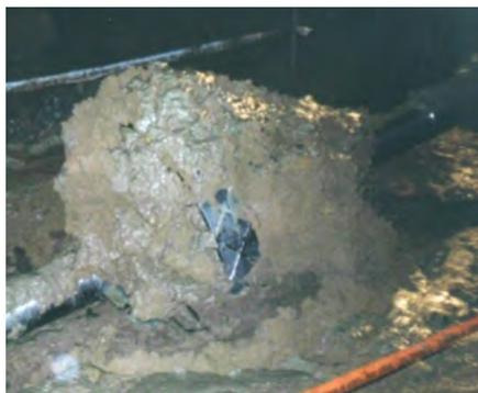
Рис. 2 — Сальник на лопастном расширителе
