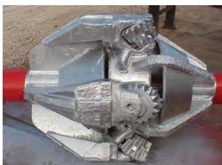
Рис. 5 — Расширитель с шарошечным вооружением конструкции INROCK
