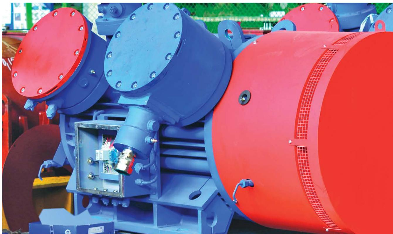
Фото 2 — Взрывозащищенный электродвигатель с повышенным КПД и сниженным уровнем шума
