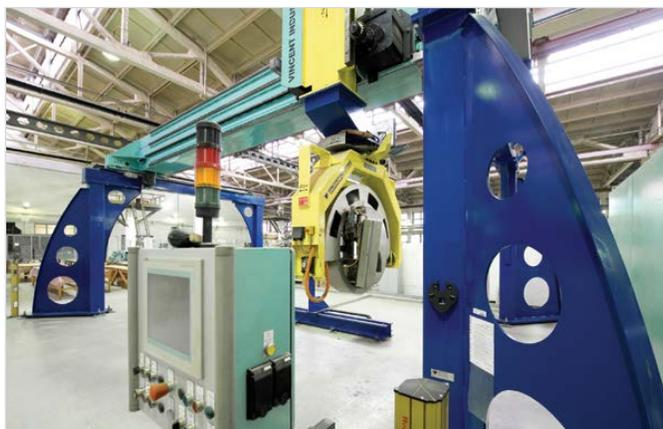
Фото 5 — Формовочный станок для изготовления катушек
