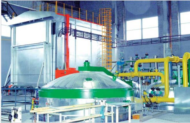
Фото 7 — Вакуумно-нагнетательный пропиточный комплекс «Монолит»
