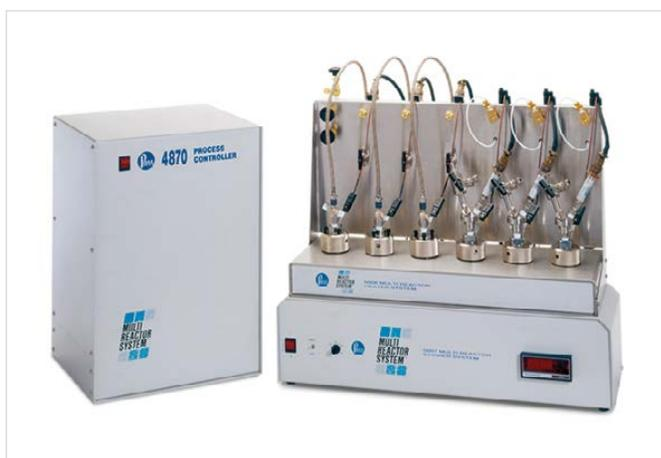
Рис. 3 — Многоячейная лабораторная установка «Parr Multiple Reactor Heater System 5000 Series»
