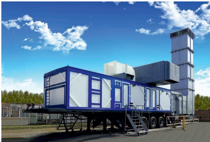
применяется газотурбинный привод (ГТП) ГТЭ-МС-2,5 номинальной мощностью 2,5 МВт, обладающий высокой надежностью (межремонтный ресурс – 25000 часов) и экономической эффективностью (К.П.Д. – 24 %).
