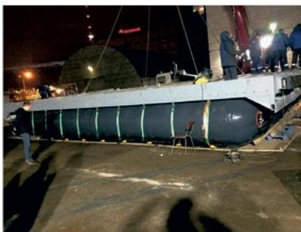
Эта конструкция способна выдержать до 60 тонн груза, а перемещать такие мега-сани будут три мощных трактора. Все детали платформы в начале ноября были погружены на судно «Академик Федоров», и уже через 2 месяца пройдут ходовые испытания возле станции «Прогресс» в Антарктике. Исследователи намерены решить главную задачу — углубиться в материк и в 2020–2021 годах возвести там станцию. Сани на баллонах, изготовленных «Политехникой», помогут им в этом.
