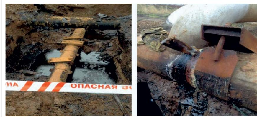
Рис. 2 — Последствия коррозионных разрушений
