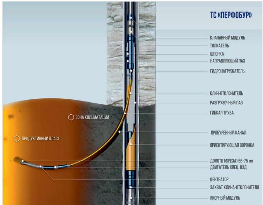
Рис. 1 — Компоновка технической системы (ТС) «Перфобур»
