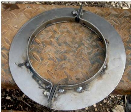
Рис. 5 — Диск-маслоотражатель
