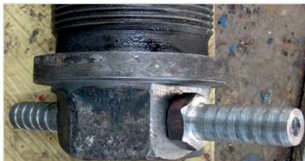
Рис. 6 — Модифицированная сливная пробка
