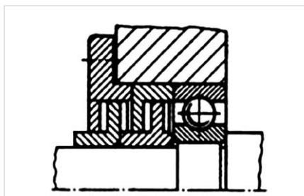
Рис. 2 — Лабиринтное уплотнение вала
