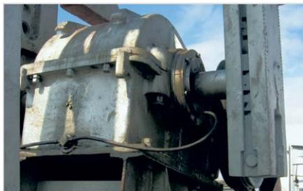
Рис. 7 — Система сбора утечек масла в сборе
