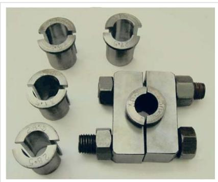
Рис. 7 — Зажим устьевого штока со вставками различных диаметров
