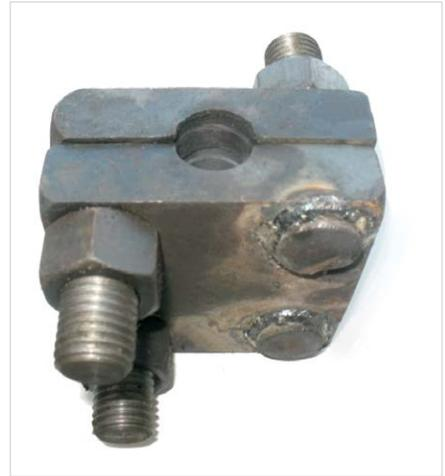
Рис. 6 — Конструкция зажима полированного штока с зубчатыми сухарями
