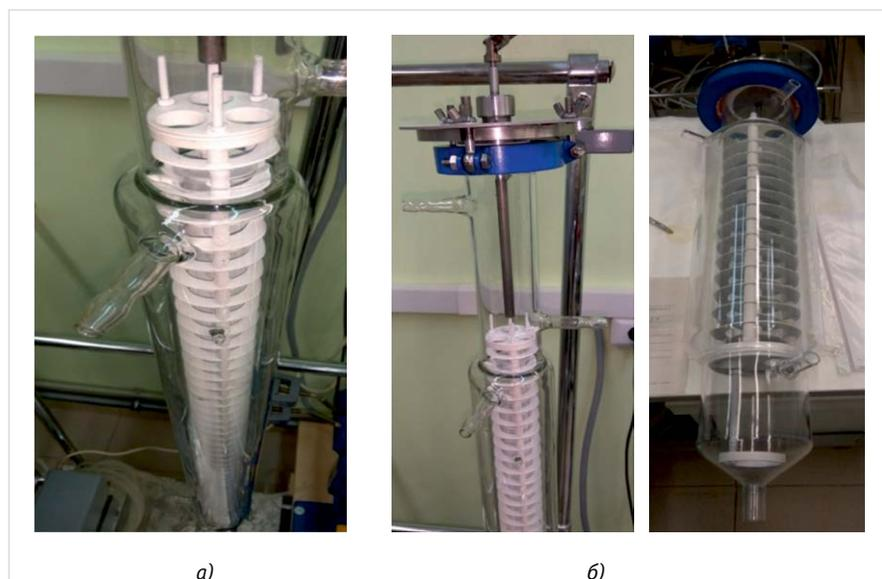
Рис. 1 — Лабораторные аппараты, внутренним диаметром 45 (а) и 100 мм (б)
