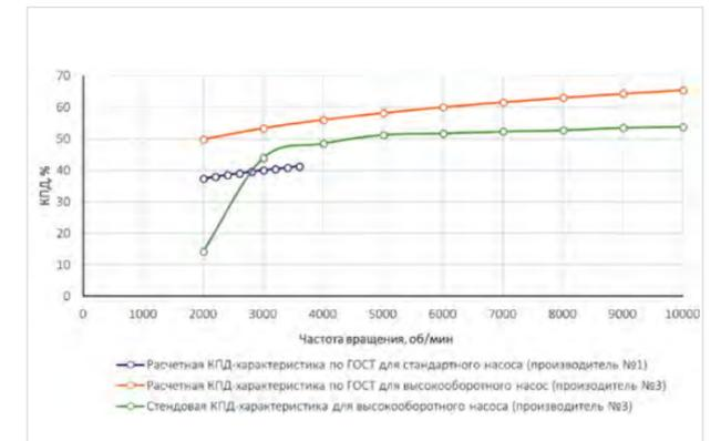
Рис. 4 — Расчетные (паспортные) и стендовая КПД-характеристики насосов производителей №1 ГОСТ для производителя №1 и №3
