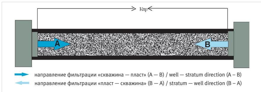
Рис. 4. Схема направления потоков фильтрации
