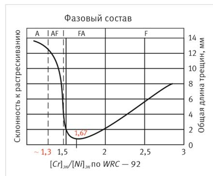
Рис. 2. Зависимость склонности сварных соединений к кристаллизационным трещинам от значения  $Cr_{ЭК}/Ni_{ЭК}$
