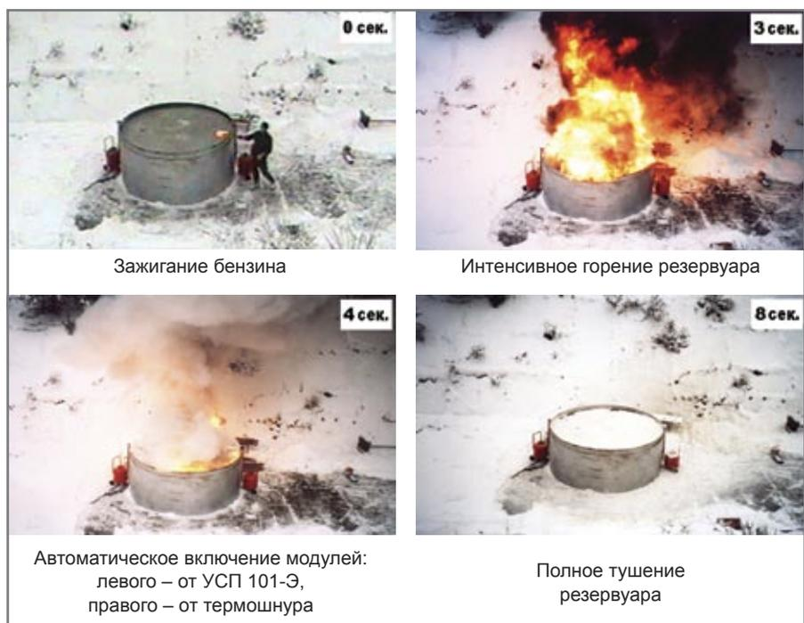
Рис. 3. Циклограмма автоматического тушения резервуара V = 15 м<sup>3</sup> с бензином А-80 двумя модулями ОПАН-50
