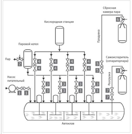
Рис.1 – Схема автоклавного производства
