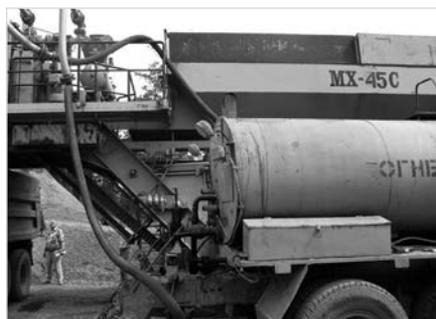
Рис. 2 — Процесс приготовления и выгрузки готовой ОМС
