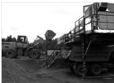
Рис. 1 — Процесс погрузки инертных материалов в бункера MX-45
