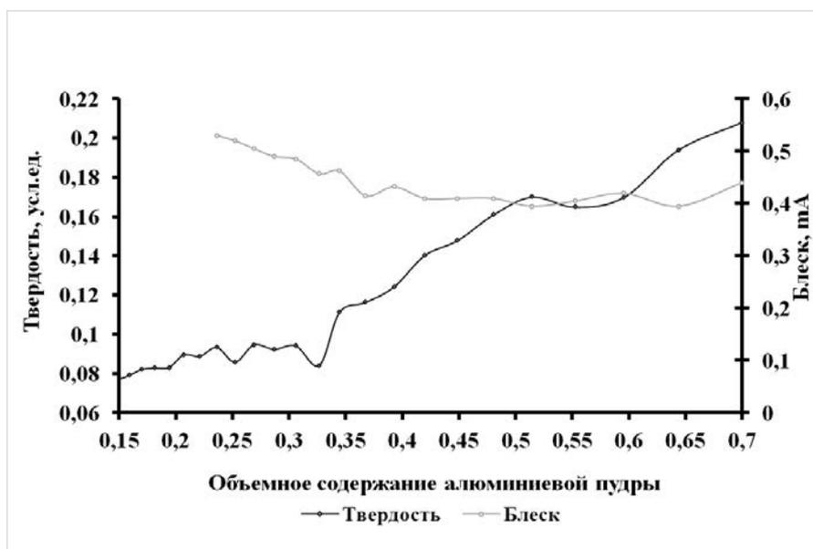
Рис. 5.21 — Зависимость физико-механических свойств БИМ от объемного содержания пигмента (ОСП)
