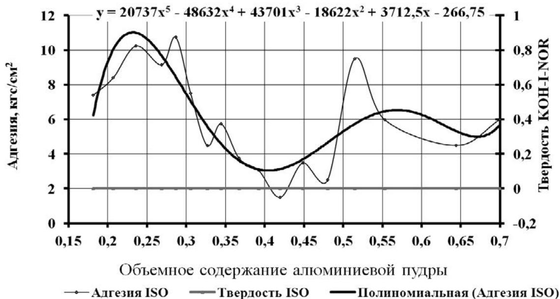
Рис. 5.23 — Прочностные характеристики Пк
