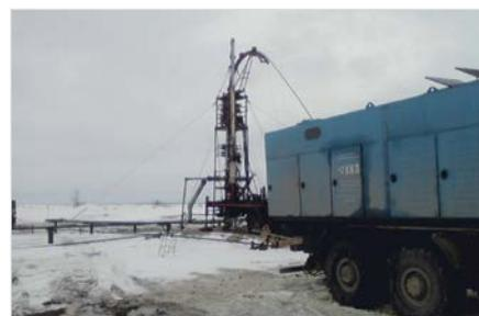
Рис. 5 — Самоходная азотная станция на объекте
